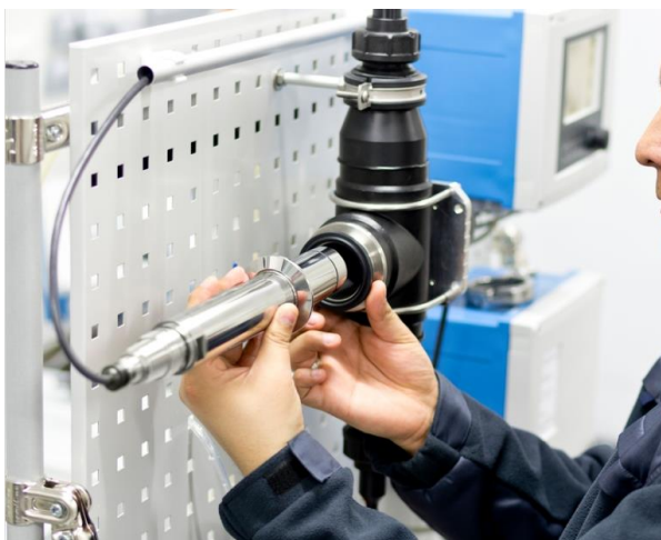
Sensor CUS52D instalado en un CUA252 de material no reflectivo
