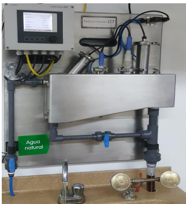
Panel para medición de cloro libre, ozono, bromo, dióxido de cloro o cloro total + pH, ORP, conductividad u oxígeno
